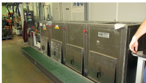
Machine à ultrason pour le nettoyage des moules
