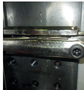
Exemple de dispositif de bridage manuel restant à demeure sur plateau
