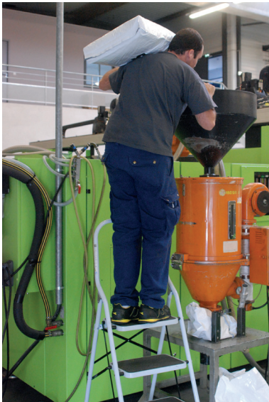
Accès en hauteur non sécurisé au colorateur par un escabeau
