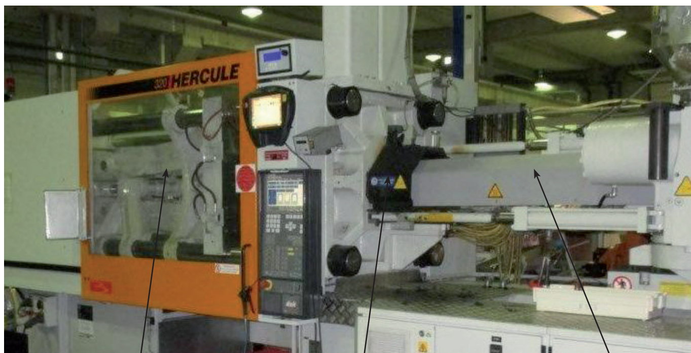
Porte et partie moulage
