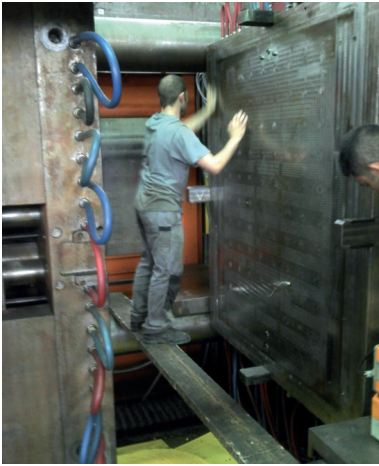
Accès non sécurisé sur support posé sur les colonnes
